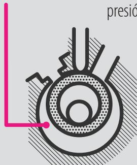
**2.** La sección comienza a absorber gas a baja presión para comprimir a continuación esta progresión, incrementando la presión del gas.
