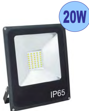
Proyector SMD LED 6.000°K IP65 - Lumens: 1400 - Medidas: 182x141x47 mm.
