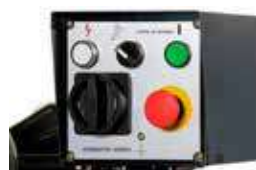
Panel de control con selector de bajada manual o controlada
