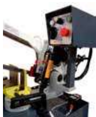
Panel de control con selector de bajada manual o controlada
